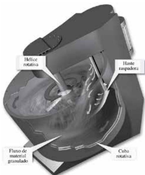
Figura 4.49. Misturador-granulador de alta intensidade [3].
