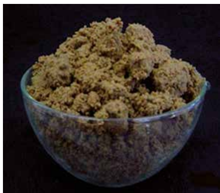
Figura 4.67. Imagem de lama de filtração de água, tal como é gerada na unidade da Asseiceira [16].
