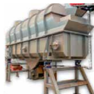
Figura 4.50. Granulador horizontal com secador de leito fluidizado [4].
