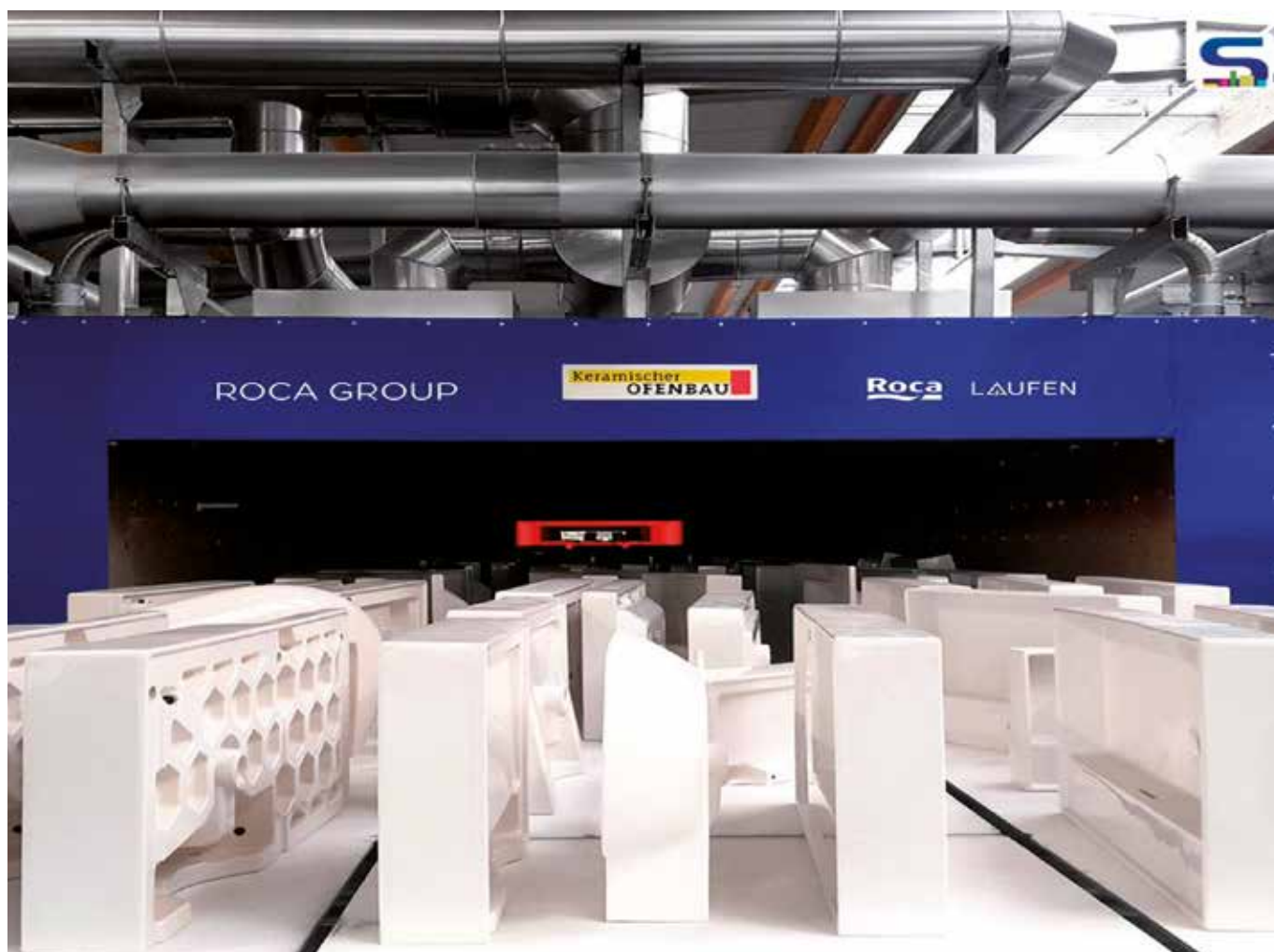
Figura 4.19. Forno de túnel elétrico para a cozedura de louça sanitária.
