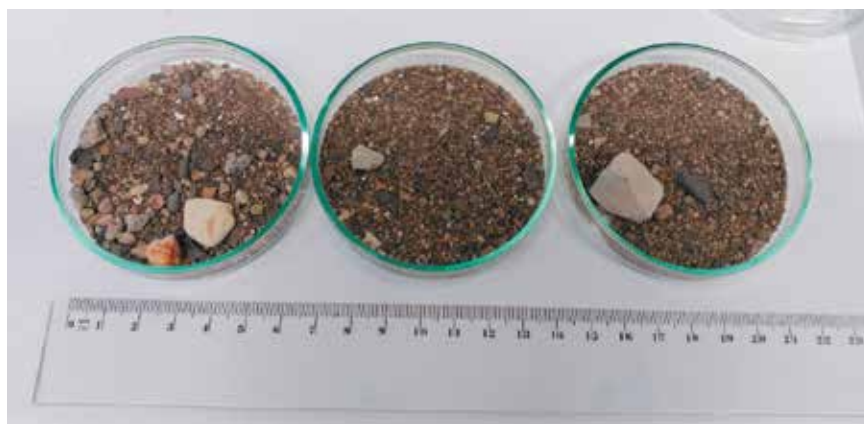
Figura 4.63. Imagens de areias purgadas de caldeira de leito fluidizado, recolhidas em períodos distintos.
