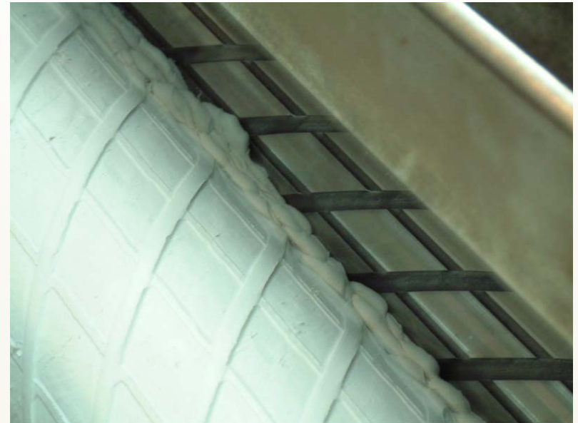
Pormenor do material na zona de corte na misturadora de rolos
