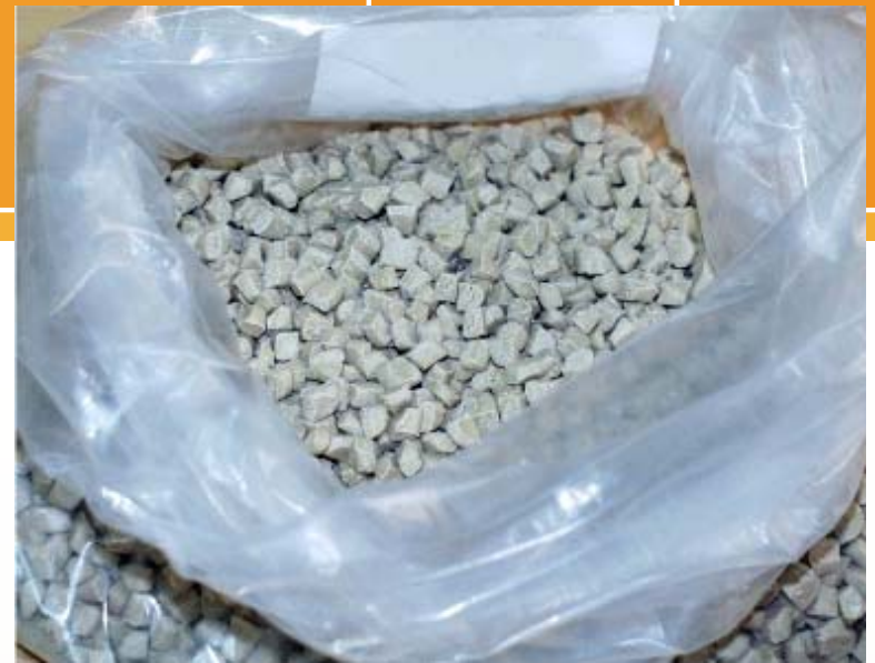
Feedstock de porcelana granulado obtido da misturadora de rolos
