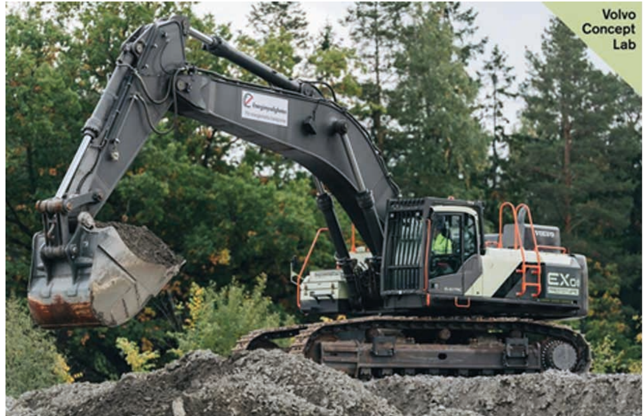
▶ Protótipo de escavadora EX01 de alimentação dupla e alimentação por cabo (Fonte: Volvo CE).
